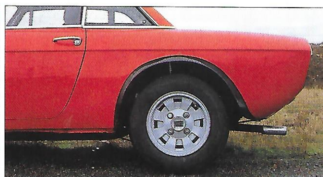
Les jantes en alliage de 6 x 13" nécessitent le montage d'élargisseur d'aile. La HF seconde série en sera dépourvue et les jantes passeront en 14" de diamètre.
