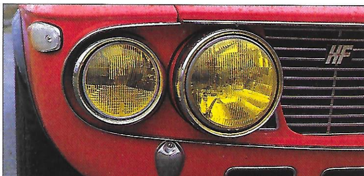
Caractéristique de la première série, les gros Carrello « longue portée » sont plutôt vulnérables : ne pas se garer « à l'oreille »!
