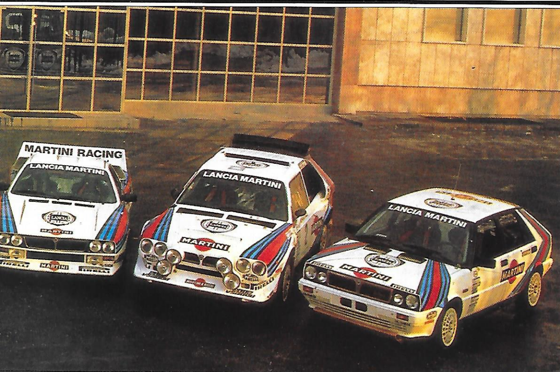
Les jantes en alliage de 6 x 13" nécessitent le montage d'élargisseur d'aile. La HF seconde série en sera dépourvue et les jantes passeront en 14" de diamètre.
