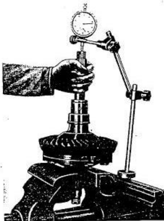
Fig. 19. - Contrôle jeu axial entre satellites et planétaires.
