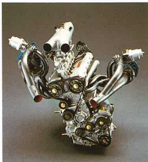
A bas régime déjà, le quatre-cylindres en ligne reçoit l'assistance du petit turbo. Le gros se met en marche à plus haut régime et permet au moteur de 1,8 litre de développer 600 chevaux.
