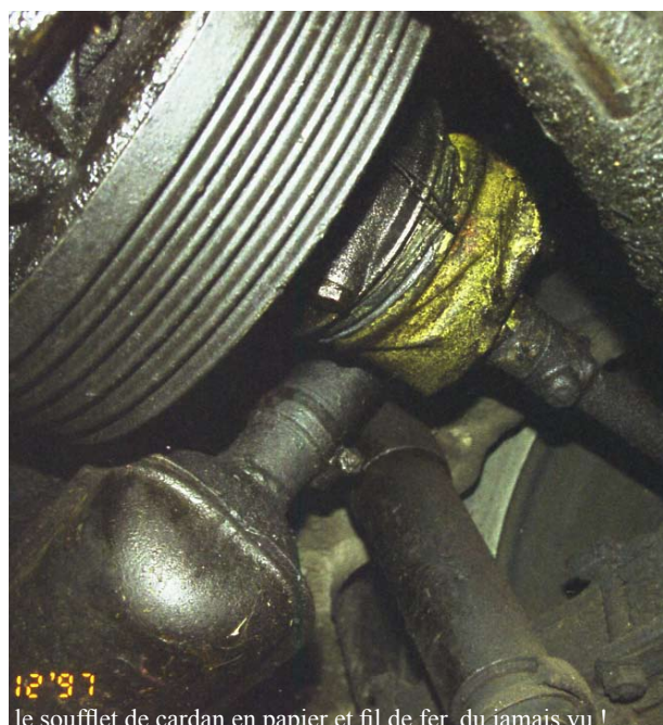
le soufflet de cardan en papier et fil de fer, du jamais vu !
