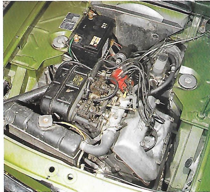
Ci-dessus, notez la disposition peu commune du... V4 Lancia ! Un bien beau double arbre comme les italiens savent les faire...
